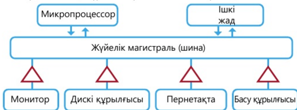
1.3.4-сурет. Дербес компьютердің құрылымы (үшбұрыштар – контроллерлер)
