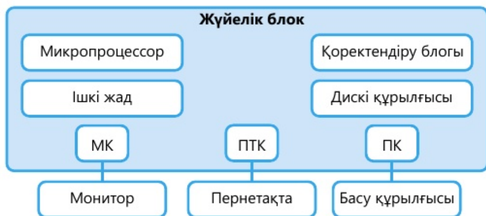
1.3.3-сурет. Компьютер құрылғыларының минималды жиынтығы МК – монитор контроллері, ПТК – пернетақта контроллері, ПК – басу құрылғысы контроллері
