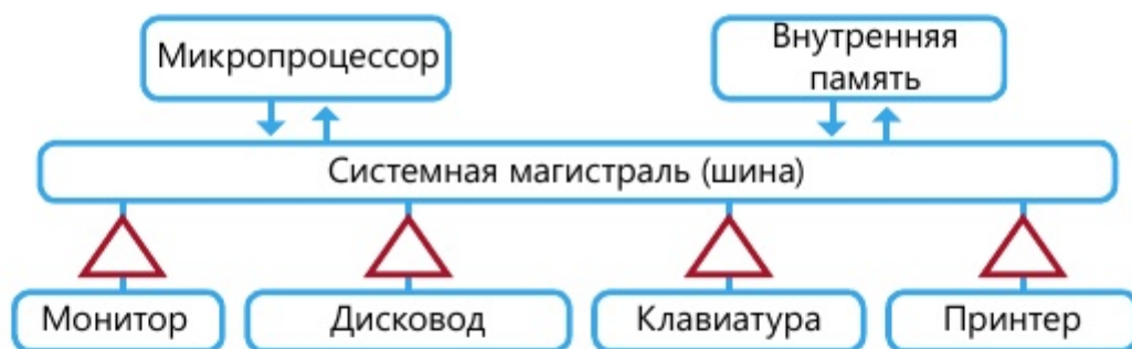
Рис. 1.13. Структура персонального компьютера (треугольники – контроллеры)
