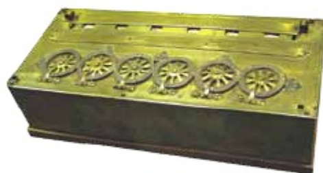
Рис. 1.6. Арифмометр Б. Паскаля
