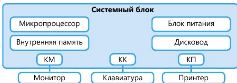
Рис. 1.12. Минимальный комплект устройств компьютера (КМ – контроллер монитора, КК – контроллер клавиатуры, КП – контроллер принтера)
