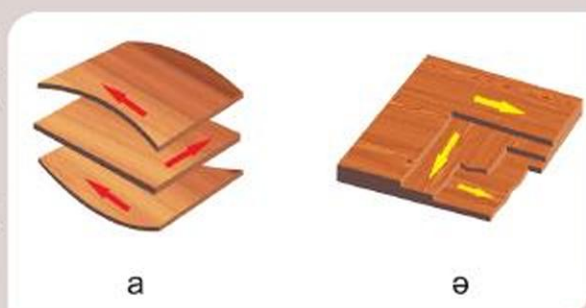
Үш қабатты фанердің схемасы: а – шпон табақтарының орналасу бағыттары; ө – табақтарды нығыздау
