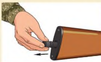
4.4-сурет. Дүмдегі ұяшықтан керек-жарақтар пеналын шығару
