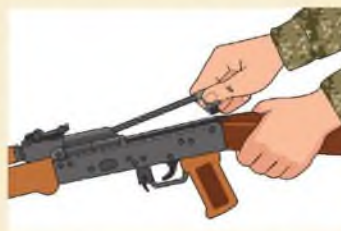
4.8-сурет. Қайтару механизмін шығарып алу
