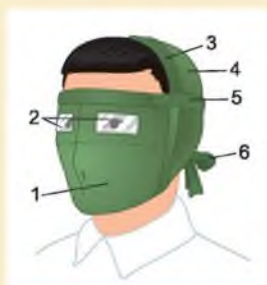
8.11-сурет. Шаңға қарсы мата бетперде: 1 – бетперде корпусы; 2 – көру тесігі; 3 – бекіткіш; 4 – резина таспа; 5 – көлденең резеңке; 6 – баулар
