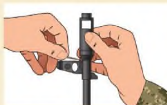
4.6-сурет. Тежеуіш-компенсаторды ажыратып алу
