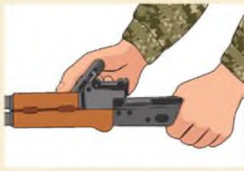
4.11-сурет. Көмекші жарақтың көмегімен газ түтігі тұйықтаушысын бұру
