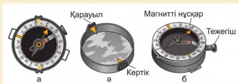
6.1-сурет. Адрианов компасы: а – жалпы көрінісі; ә – көздеуге (визирлеуге) арналған тетігі бар компас қақпағы; б – лимб, нұсқар және тежегіш
