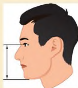
8.9-сурет. P-2 респираторының қажетті өлшемін анықтау
