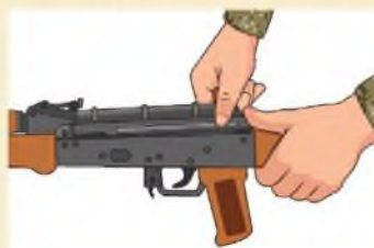
4.7-сурет. Ұңғы қорабының қақпағын ажыратып алу
