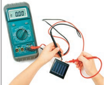
36-сурет. Мультиметр арқылы тұрақты ток көзінің ЭҚК-сын өлшеу
