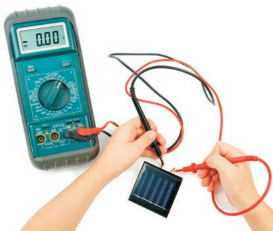
25-сурет. Мультиметр арқылы тұрақты ток көзінің ЭҚК-сын өлшеу
