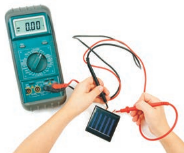
Рис. 25. Измерение ЭДС источника постоянного тока мультиметром
