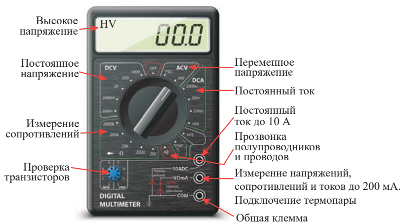
Рис. 26. Панель мультиметра с указанием режимов работы
