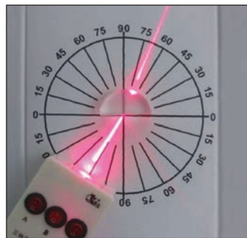
Рис. 96. Определение показателя преломления стекла с помощью оптического диска
