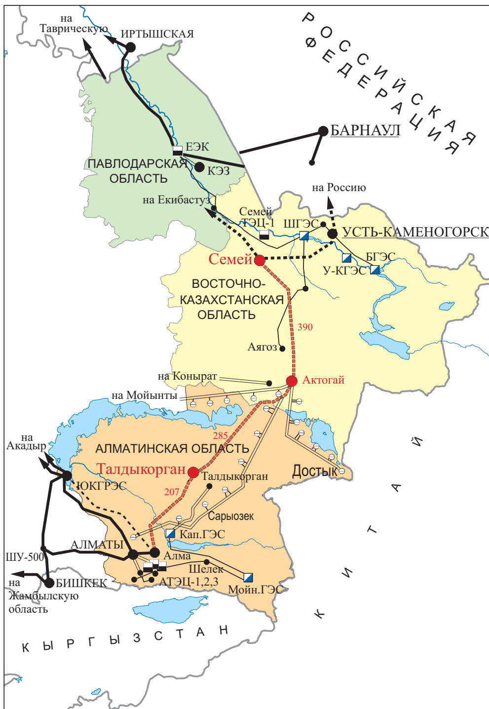
Рис. 44. ЛЭП «Семей – Актогай –Талдыкорган – Алматы» ----- Существующие ЛЭП, ===== Построенные ЛЭП к 2018 г.
