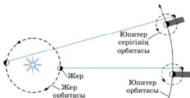
5.1.1-сурет. Жарық жылдамдығын анықтауға арналған астрономиялық әдіс
