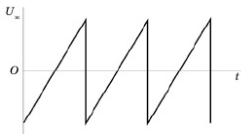
1.2.3-сурет. Кернеу тербелісінің осциллограммасы
