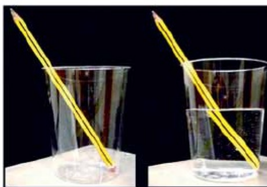
Рис. 6.3.1. Преломление предмета на границе раздела воздух – вода
