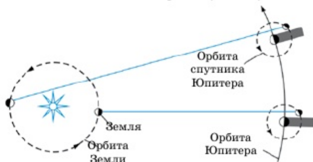
Рис. 5.1.1. Определение скорости света астрономическим методом
