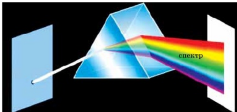
Рис. 5.2.1. Разложение белого света при прохождении его через призму
