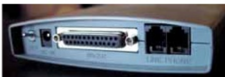
3.5.2-сурет. Асимметриялық цифрлық абоненттік желі арқылы қосылу
