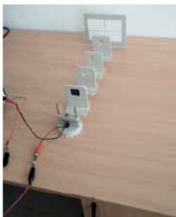
Рис. 4.3.5. Установка для наблюдения поляризации света
