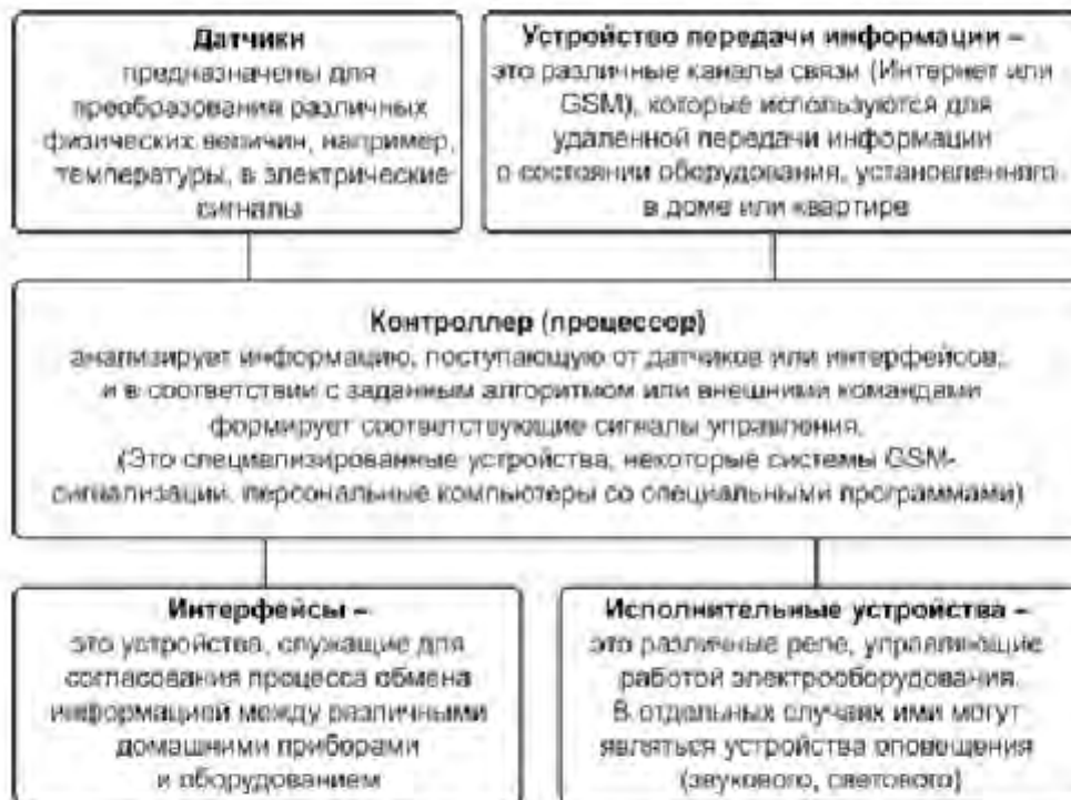
Рис. 4.2.2. Структурная схема устройств и их функциональное назначение
