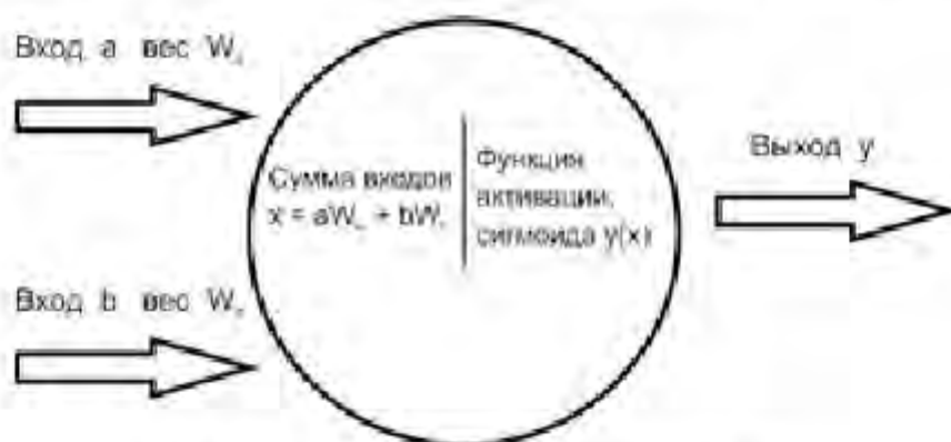
Рис. 1.4.3. Принцип работы нейронной сети
