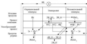
Схематическое изображение электродных процессов при разряде свинцового аккумулятора
