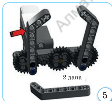
4-сурет. Роботтың қарапайым «қолын» құрастыру
