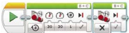
Рис. 3.8. Присоединение блока Независимое управление моторами
