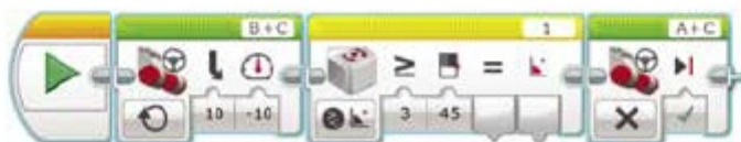
Рис. 3.14. Программа поворота робота
