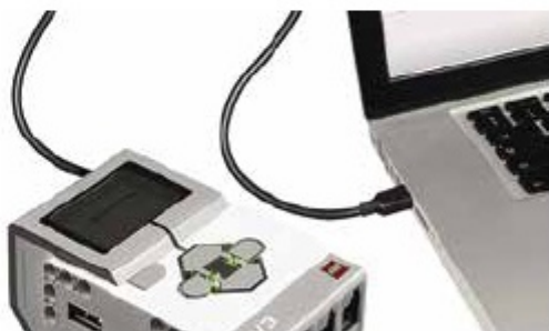
Рис. 4.20. Загрузка программы на микроконтроллер EV3
