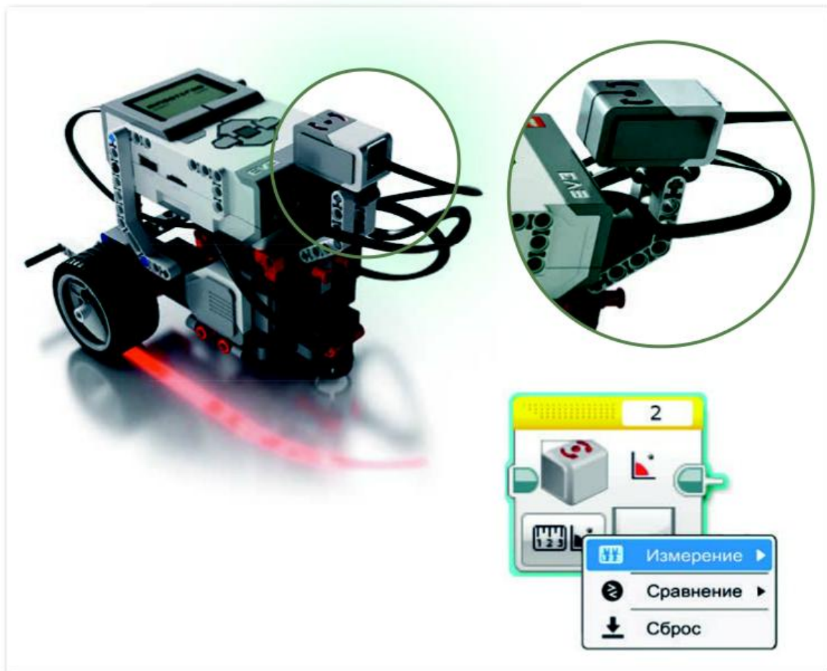
53-сурет. Гирокопиялық датчиктің орналасуы және режимдері
