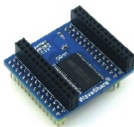
Рис. 1.6. Кэш-память в виде отдельной высокоскоростной микросхемы
