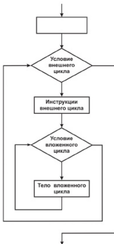
Рис. 4.4. Блок-схема вложенных циклов while
