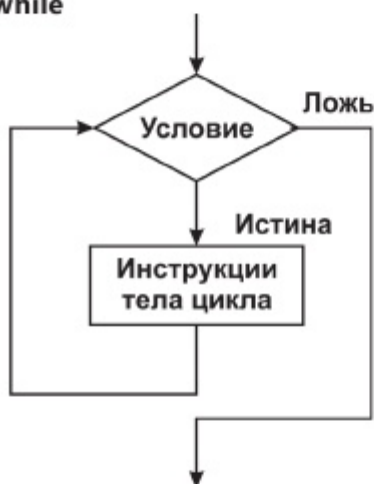
Рис. 4.1. Блок-схема цикла while
