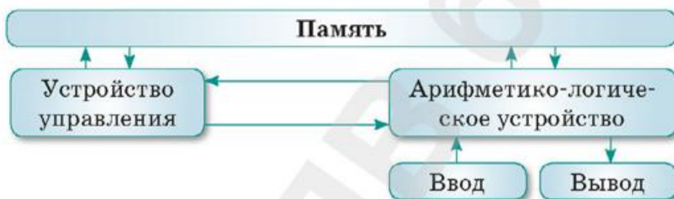
Схема 1. Архитектура Джона фон Неймана
